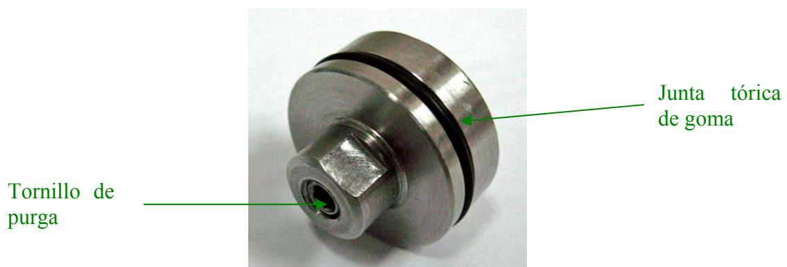
Figura 3.12 Pistón flotante alojado en la parte inferior del contenedor de muestra.
