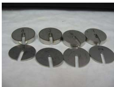
Figura 2. 7 Patrones de espesor conocido para calibrar el TDVL
