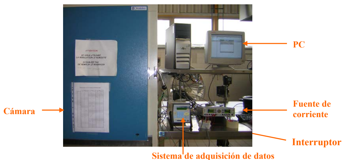
Figura 2. 12 Sistema experimental para la medida de la conductividad térmica a presión atmosférica.
